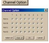
4.項目を選択します。 Item Option ボタンを 押します。項目選択ウィンドウが開きます。 条件ウィンドウの項目 にチェック(非チェック)し項目を含める(含めない)を選択します。
