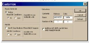
7. アクティブモードでは、 Read bit Condition ボタン をクリックし極性を選択しま す。Writeは反対の極性に なります。
